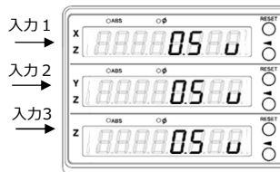
測長ユニット分解能の表示(LH71A-3)
