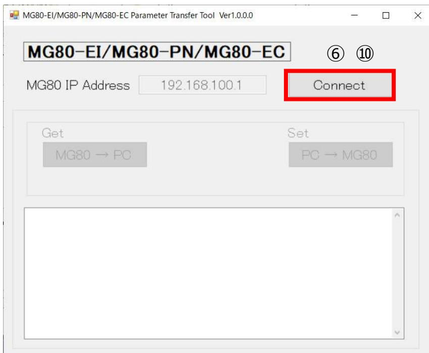
※接続に失敗する場合は、MG80 の電源を OFF し、本ツールの起動からやり直してください。
