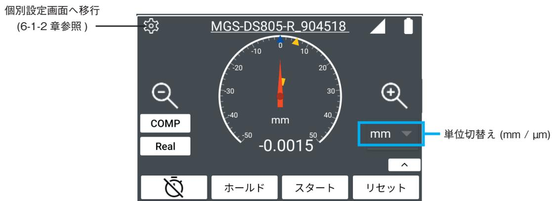
接続されている測定デバイスの内容を表示しています。項目詳細は測定デバイスの操作説明書をご参照ください。
