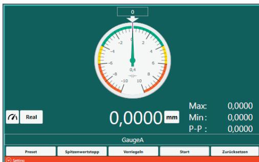
Die Operationstasten können zum Aktualisieren oder Abbrechen der Aktualisierung der Messwerte (Istwert, Maximalwert, Minimalwert, Spitze/Spitze-Wert) verwendet werden.
